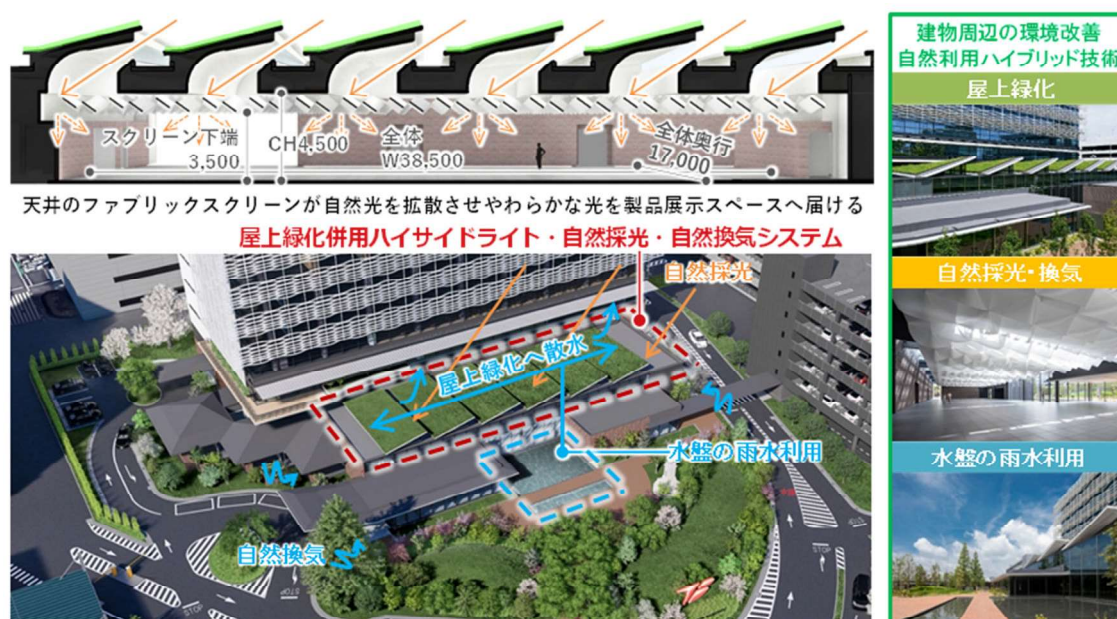
図5 屋上緑化併用ハイサイドライト・水盤の雨水利用
