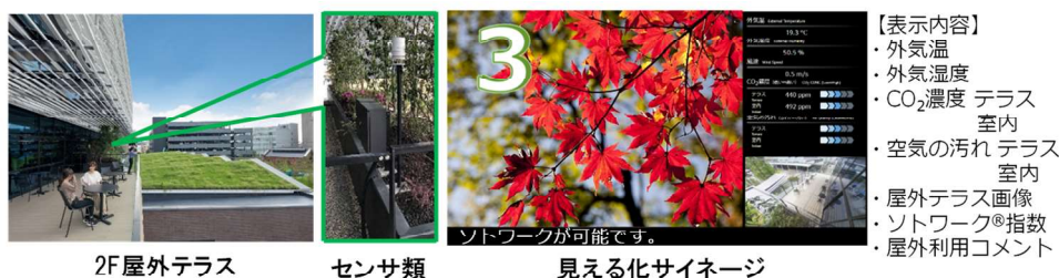
図15 屋外利用促進・空気質の見える化システム
