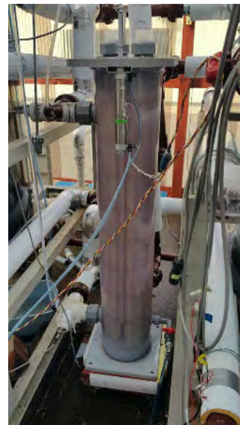
かきとり機能付きシェル&チューブ熱交換器（東京電力ホールディングス）
