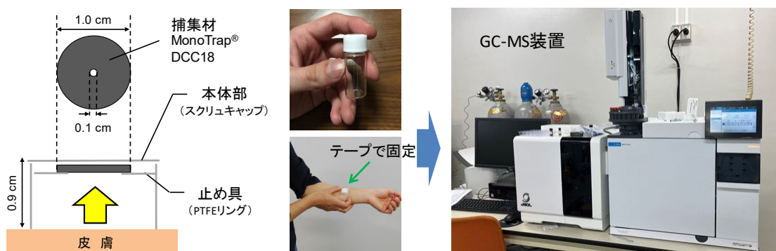
図5 VOCs測定用パッシブ・フラックス・サンプラーによる皮膚ガス捕集・分析
