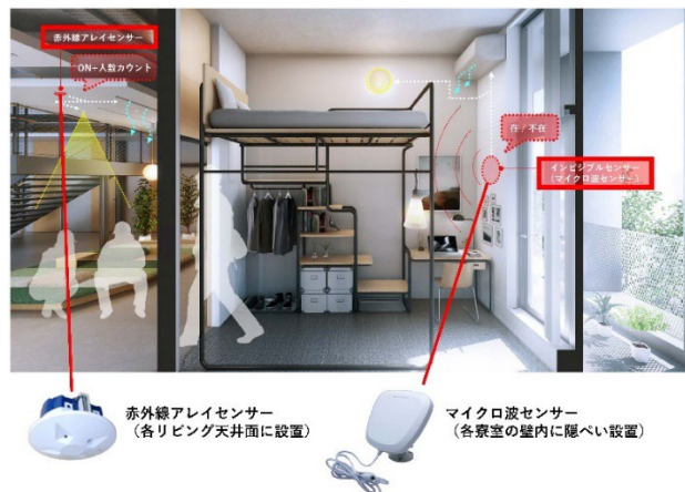
図4.3 寮室・リビングの非接触センサ概要
