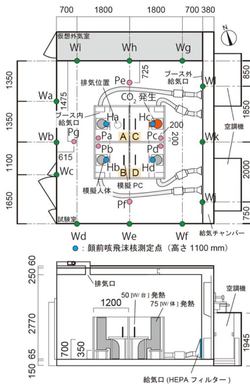
図10 ブース型置換換気実大模型室概要
