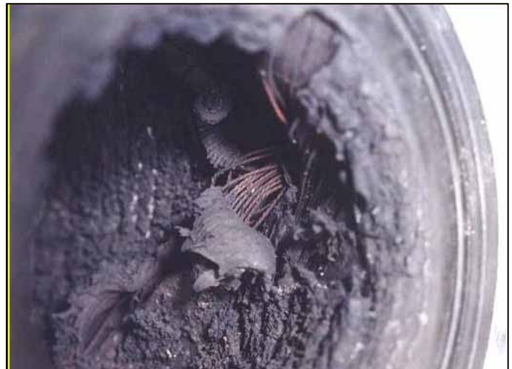
(b)球形ゴムフレキ (給湯系：使用開始後 4 年経過)
