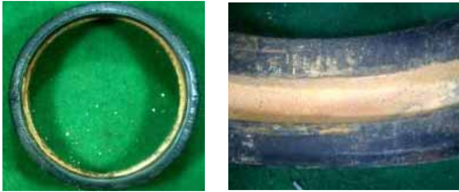
図-3 銅害によるダメージを受けたEPDMパッキンの表面写真
