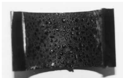
写真 3 塩素水浸漬によるカーボンブラック入り PE の水泡
