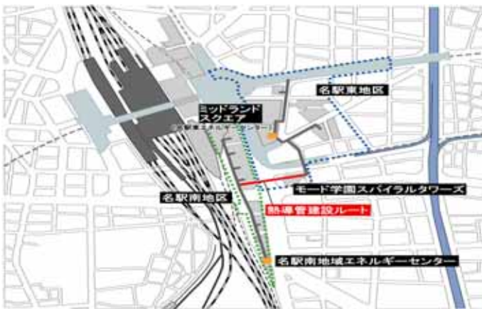
図 10 ネットワーク配管のルート設定
