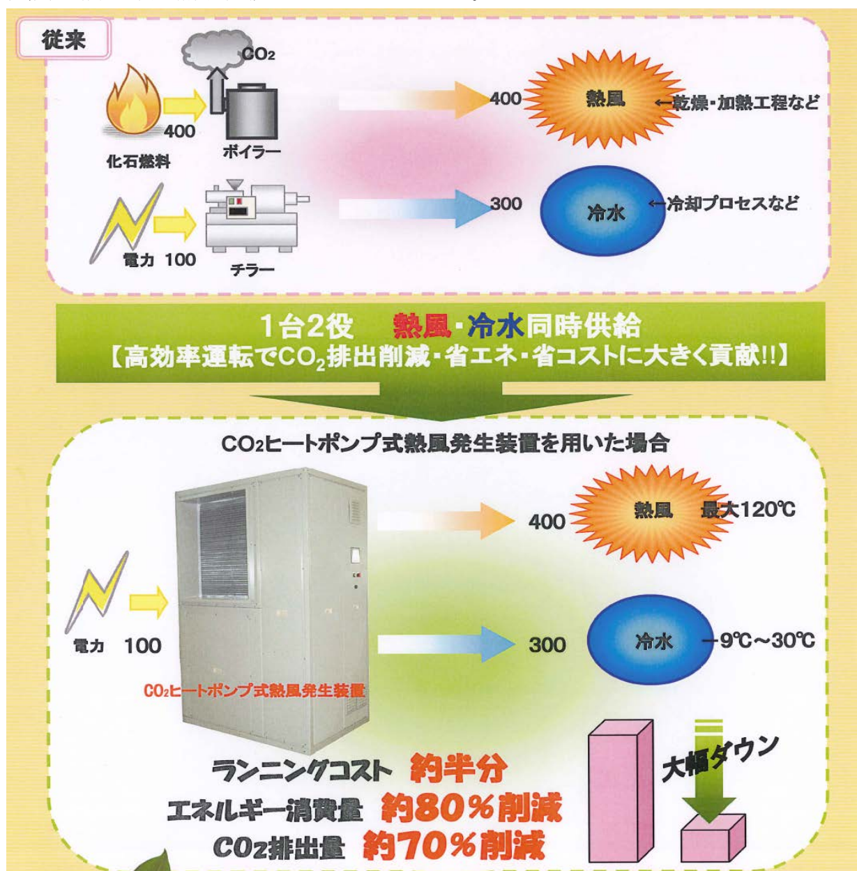
図 6 CO 2 ヒートポンプ式熱風発生装置の概要
