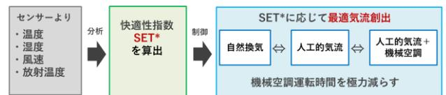
Fig.6 シーリングファン制御フロー
