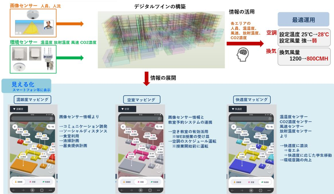
Fig.2 デジタルツインを活用した設備最適制御・見える化
