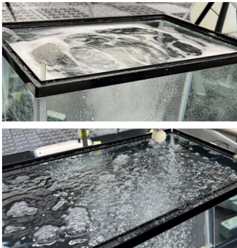
写真-1 実験時の水槽の様子 (上写真：海水の場合，下写真：純水の場合)
