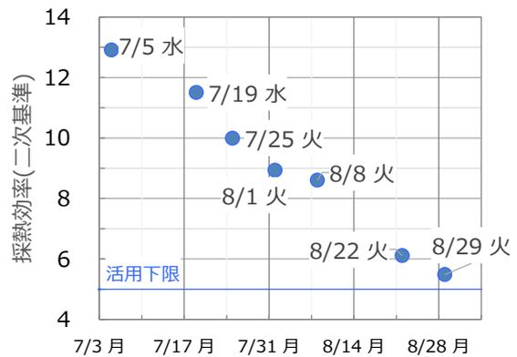
図 9 夏期の(6-8月)の地中熱の採熱効率(二次基準)
