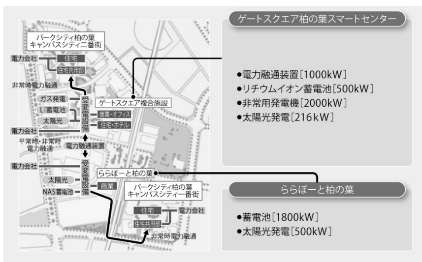
図5 柏の葉キャンパスシティの自営線マイクログリッドシステム (©NSRI)
