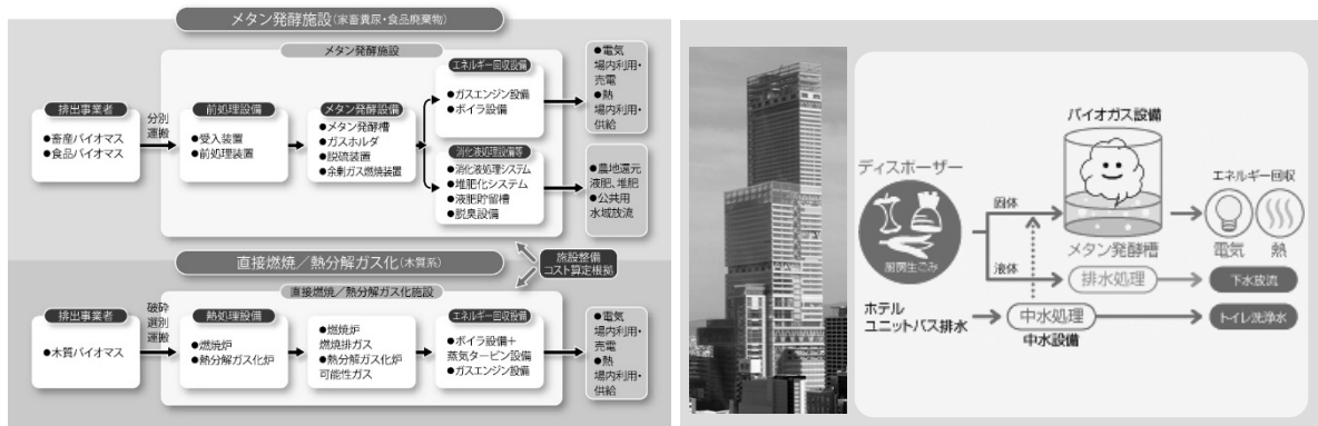
図8 バイオマスによるエネルギー化フローとあべのハルカスのバイオガス発電システム 5)
