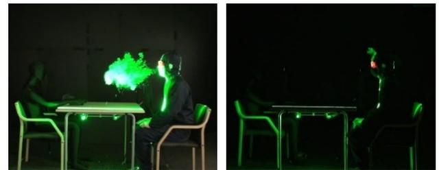
図14 模擬粉の拡散状況 (左: Case1-1, 右: Case 1-2)
