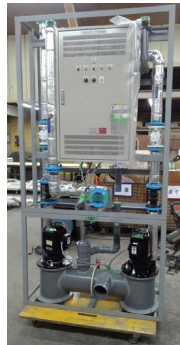
圧送排水装置 (本体)
