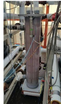
図9 かきとり機能付きシェル&チューブ熱交換器（東京電力、大阪市立大学）
