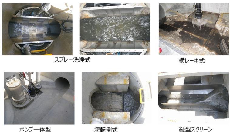
図11 試作・試験したスクリーン
