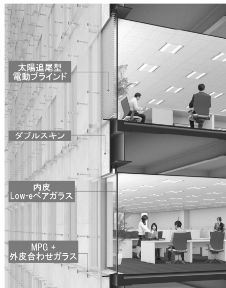
図 2 ダブルスキン概念図
