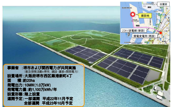
図 5 堺第 7-3 区太陽光発電所(仮称)
