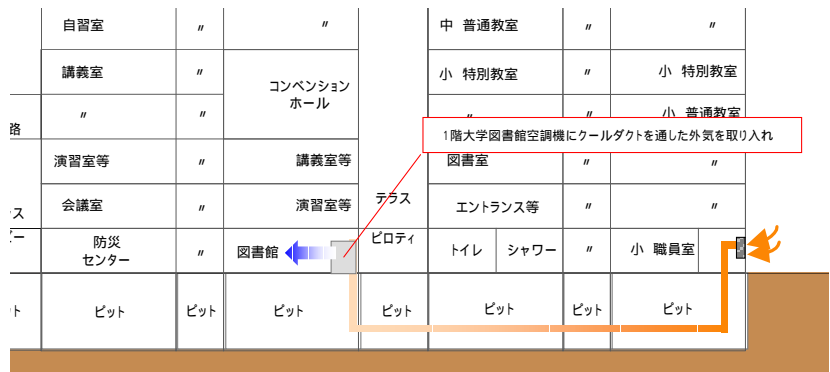
クールダクト(地熱)による外気負荷低減
