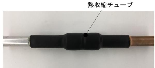
図4 熱収縮チューブによる被覆
