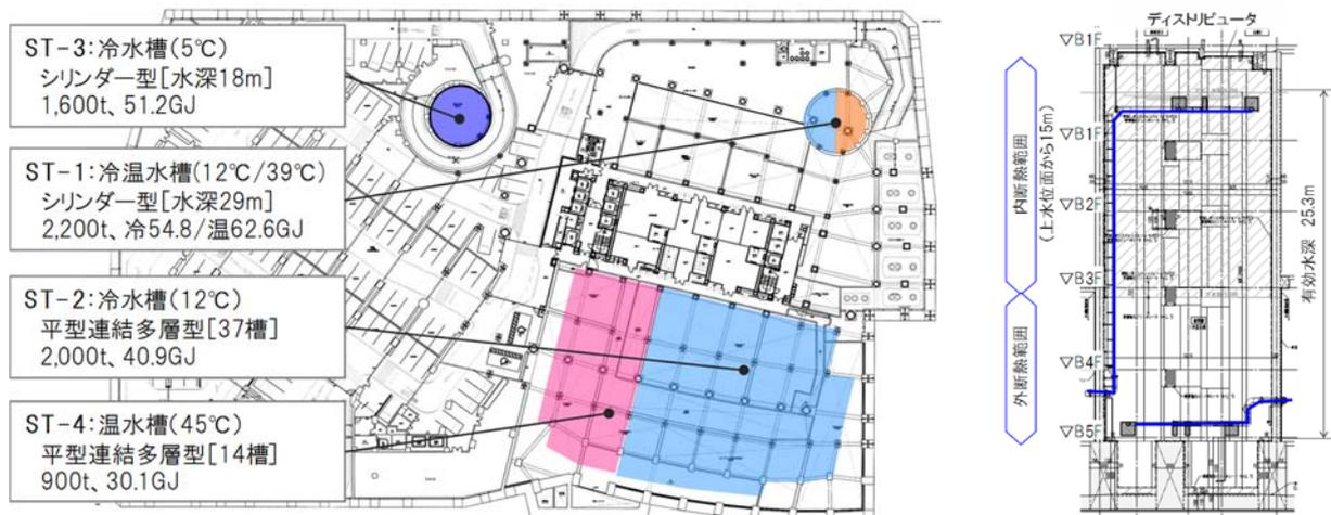
図6 蓄熱槽概要(左:平面配置図、右:ST-1断面概要)
